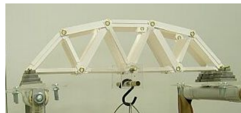
写真 L.1 ケント紙とハトメを使ったトラス模型の型紙の例と载荷条件
