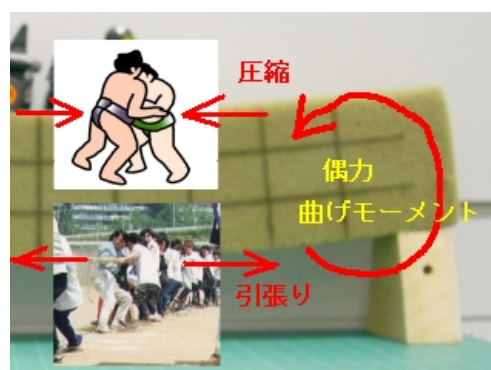
写真 1.2 上部は圧縮で下部は引張
