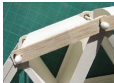
写真 L.2 バルサ板による補強
