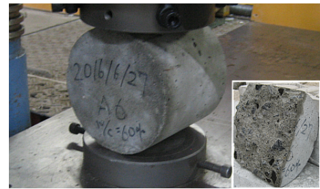
写真 3.4 コンクリートの割裂試験
